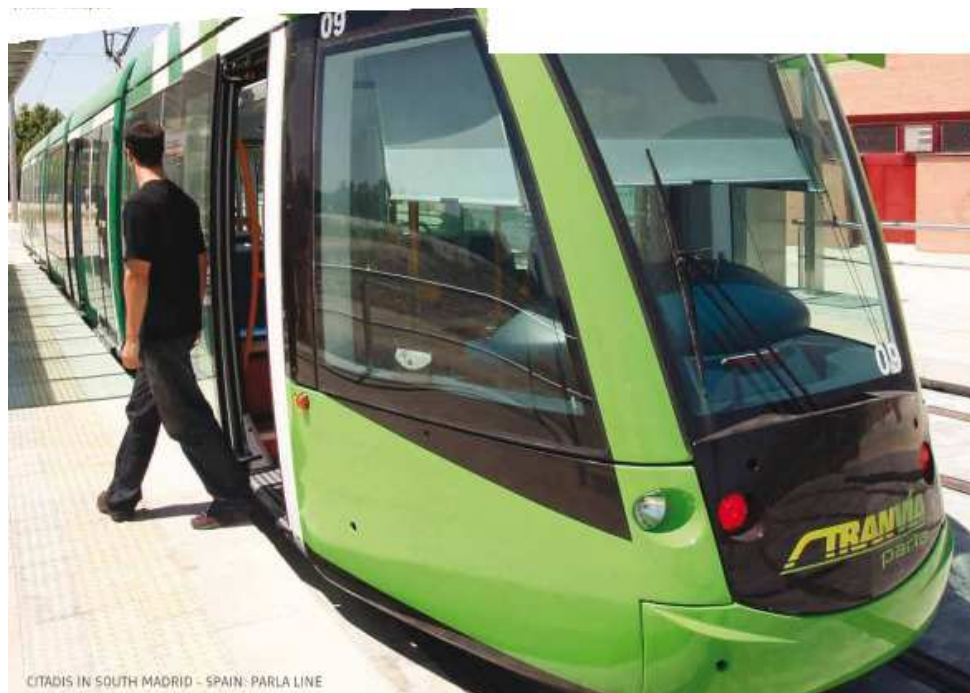
Figur 8 Overgang mellom plattform og lavgulv i en Alstom Citadis Bilde: Alstom Transport
